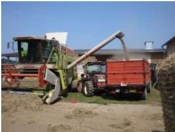
Standdrusch aufgelöster, vorher getrockneter Ballen. Im Erntegut überwiegen die Beimengungen an Spreu.
