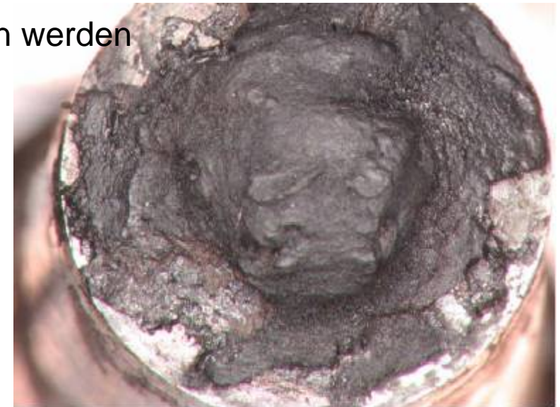
Abbildung 18: Verkokung an Düse 2 nach Prüflauf mit 50 % ROE/50 % DK
